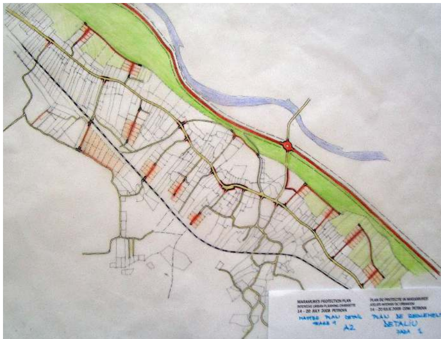
Figura 22. Planul centrului localității, cu indicarea intersecțiilor necesare a fi reconfigurate și a extinderilor propuse pentru străzi
